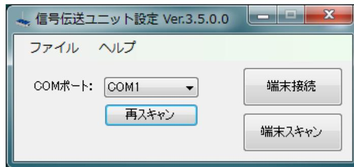
機器と接続した「COM ポート」をリストから選択し、「端末接続ボタン」をクリックします。
